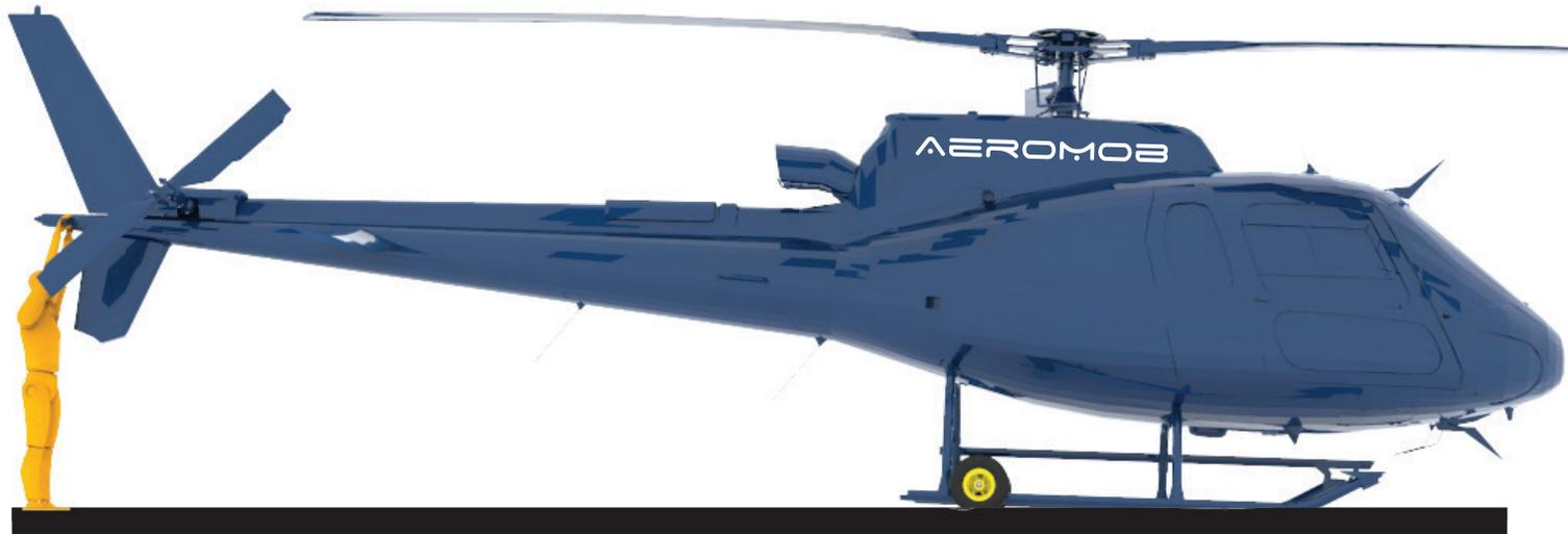
Após a movimentação da aeronave até o local desejado, o operador da cauda deverá baixar o nariz do helicóptero lentamente até o contato da parte frontal dos esquis com o solo.
