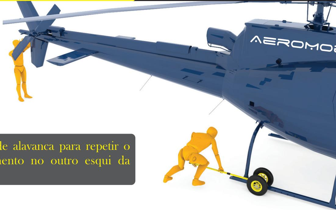
Remova a barra de alavanca para repetir o mesmo procedimento no outro esqui da aeronave.
