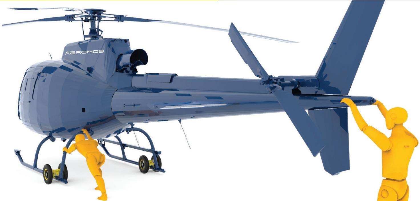
Um operador deverá puxar a cauda da aeronave para baixo com intuito de equilibra-la, enquanto o outro operador deverá puxar/empurrar a aeronave conforme a necessidade de movimentação.
