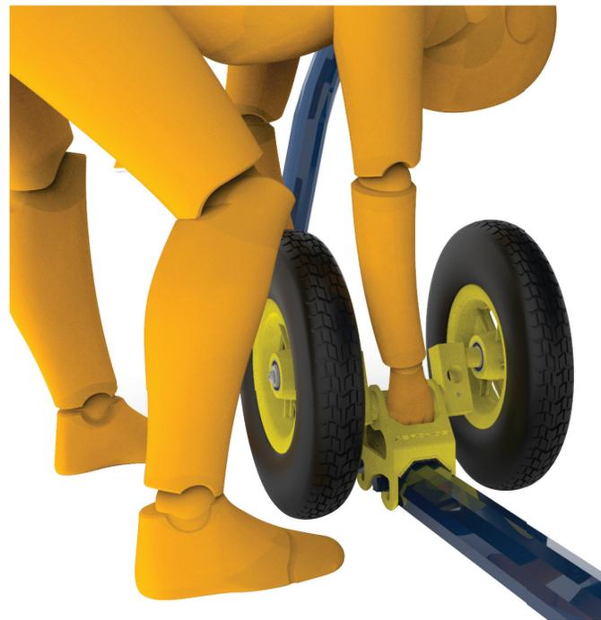
Encaixe o HELIMOB nas garras de esqui do helicóptero
