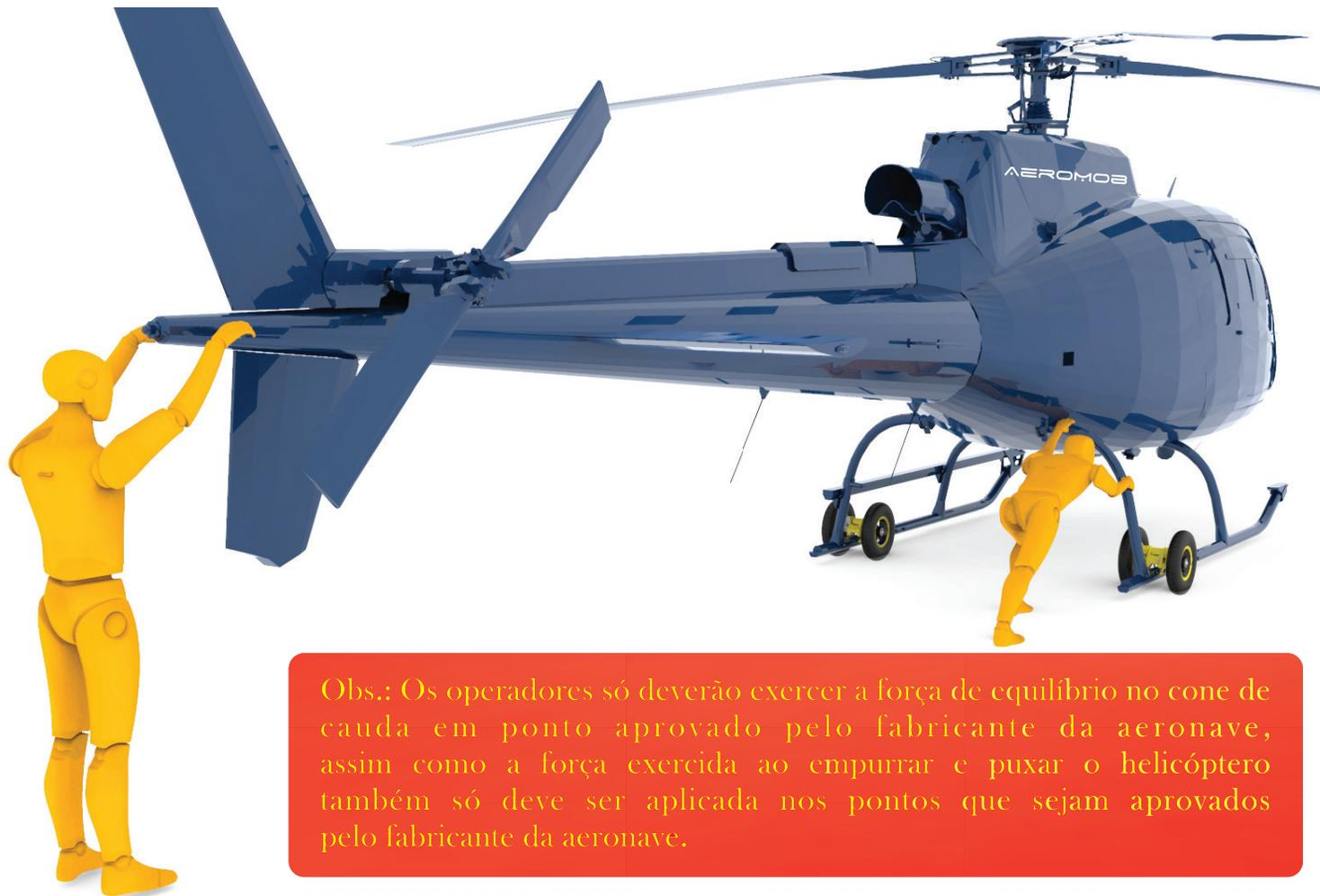
Obs.: Os operadores só deverão exercer a força de equilíbrio no cone de cauda em ponto aprovado pelo fabricante da aeronave, assim como a força exercida ao empurrar e puxar o helicóptero também só deve ser aplicada nos pontos que sejam aprovados pelo fabricante da aeronave.
