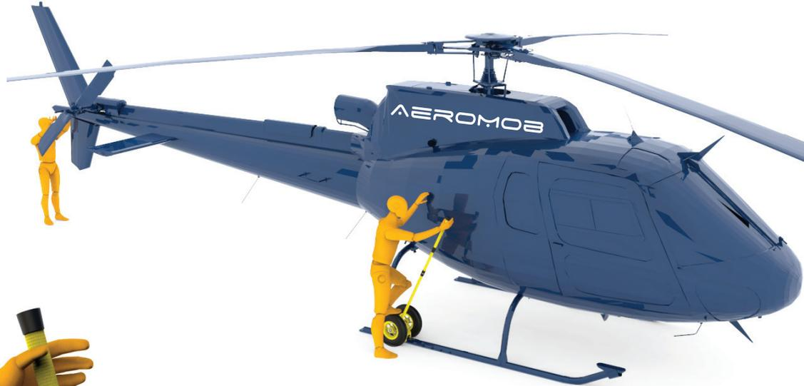
**PERIGO:** Caso o operador pegue a barra fora do ponto designado, o processo de alavancagem ficará muito pesado e irá gerar o risco da barra escorregar da mão durante o processo de alavancagem, o que causaria um giro da barra de alavanca em alta velocidade, gerando risco de colisão e de causar lesão corporal grave ou danos materiais!
